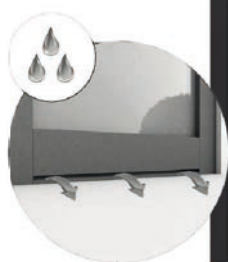
Verdeckt liegende Entwässerung im Seitenteil
